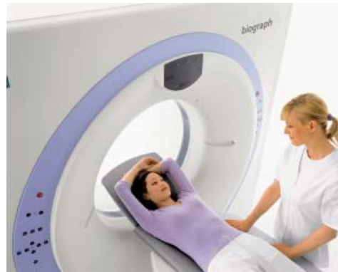
Figura 13. Apparecchiatura PET. Il paziente viene fatto sdraiare sul lettino dopo somministrazione del tracciante radioattivo a livello venoso. Successivamente, vengono acquisite le immagini per l'analisi tomografica.
