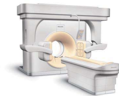
Figura 15. Apparecchiatura SPECT. È visibile ai lati del lettino la gamma camera, costituita dai due elementi fondamentali, il collimatore e il sistema di localizzazione fotonica per l'acquisizione di immagini scintigrafiche.
